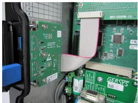
Innenansicht BC43 / BC44 mit eingebauter Ladeelektronik
